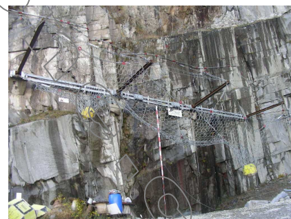
fig 5 - vista d'insieme e dettagli della sequenza dei test normati e non normati sul prototipo RAV_8/A
