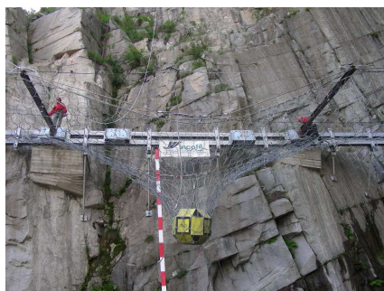
fig 1- Vista frontale del kit di classe 5 - RAV_5/A post impatto al livello SEL
